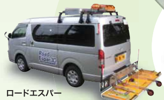
ロードエスパー 車両と一体型で 三次元の地中データを取得します ● 探査可能深度(1.5m程度)
