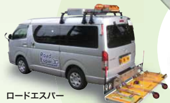
ロードエスパー 車両と一体型で 三次元の中地データを取得します ● 探査可能深度(1.5m程度)
